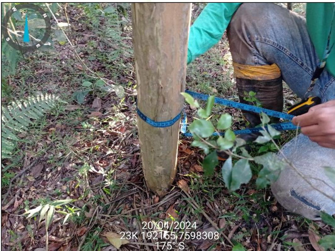
Figura 9 - Mensuração de diâmetro à altura de 30 cm acima do nível do solo (definição de área basal em áreas do Bioma Cerrado).
