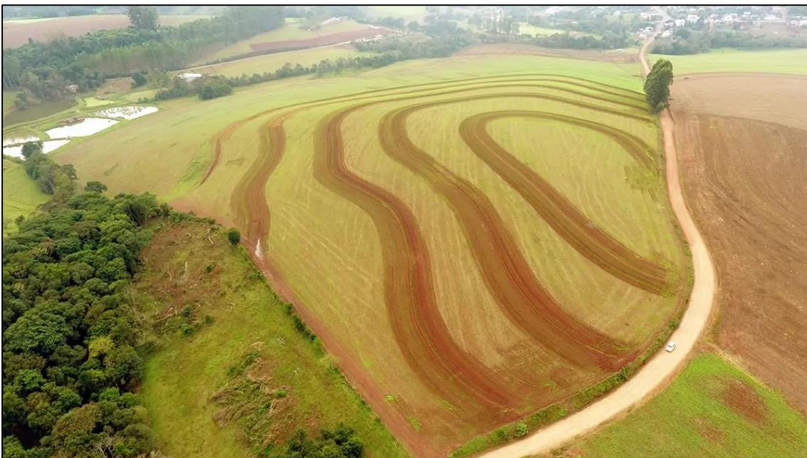
Figura 187 - Exemplo de terraceamento agrícola para conservação do solo e controle de erosões.
